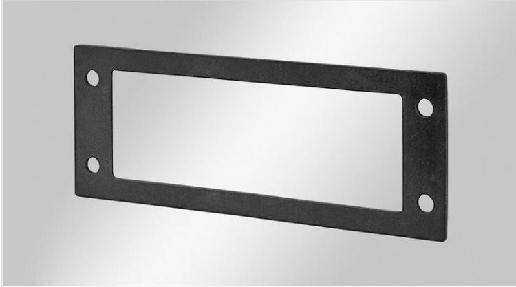
Um eine saubere Abdichtung zwischen Kabledurchführung und Gehäuse-/Schaltschrankwand zu gewährleisten, ist eine Flachdichtung vorgesehen. Diese wird zwar standardmäßig mitgeliefert, kann aber auch einzeln bestellt werden. Die Standarddichtungen für unsere KEL Kabeleinführungsleisten sind einseitig selbstklebend. Dies erleichtert die Ausrichtung und Montage der Dichtung.
